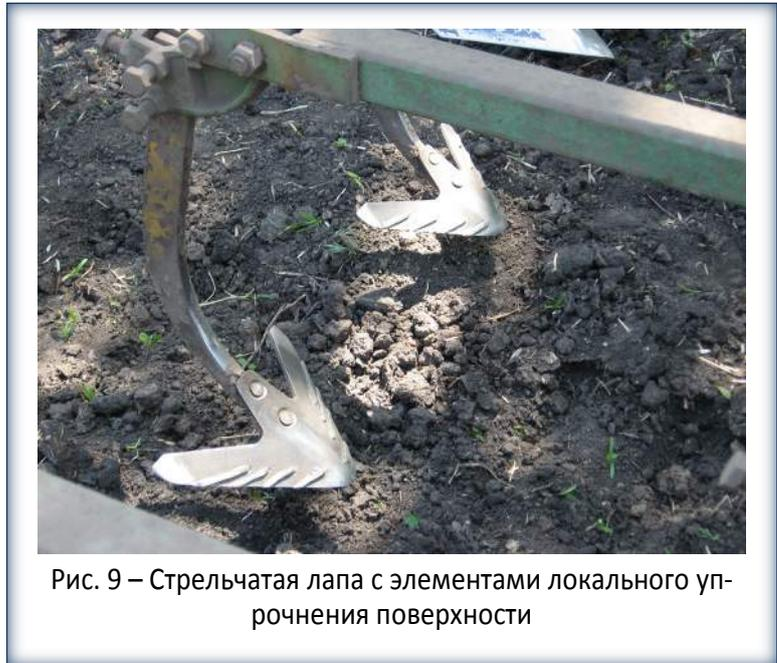
Рис. 9 – Стрелчатая лапа с элементами локального упрочнения поверхности
