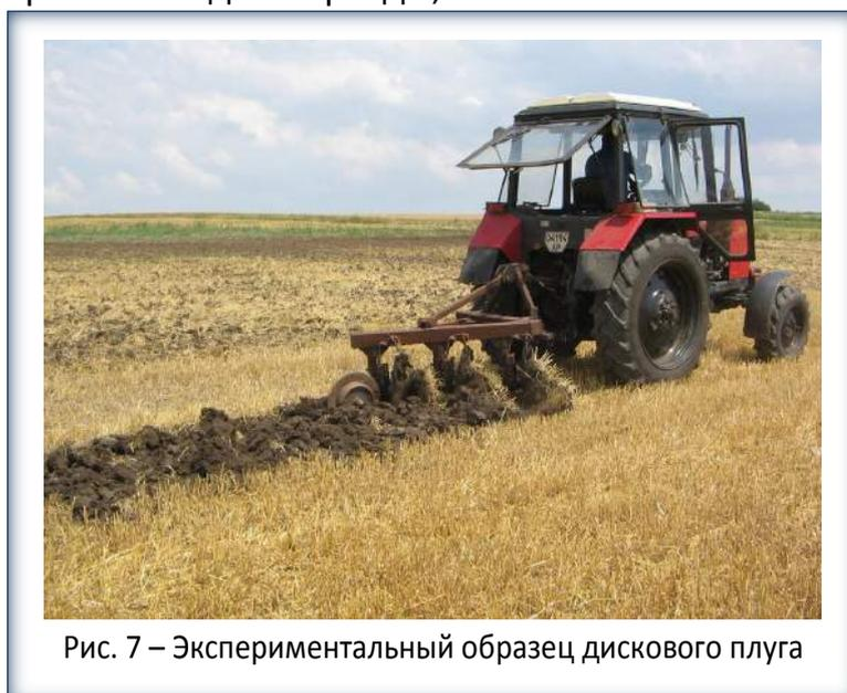
структурности оптимальными для типовых условий центра Украины следует считать  $\alpha = 31^\circ$ ;  $\beta = 26^\circ$ . Диаметр диска 660 мм при глубине обработки (18-22) см. Это соответствует параметрам рамы:  $\Delta = 545$  мм;  $\Delta_1 = 285$  мм;  $\theta = 28^\circ$ .
